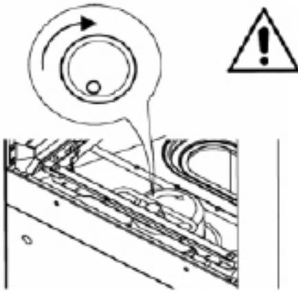
Vérifier que le sens de rotation correspond à l'illustration et aux marquages sur le mouvement de traction central.
